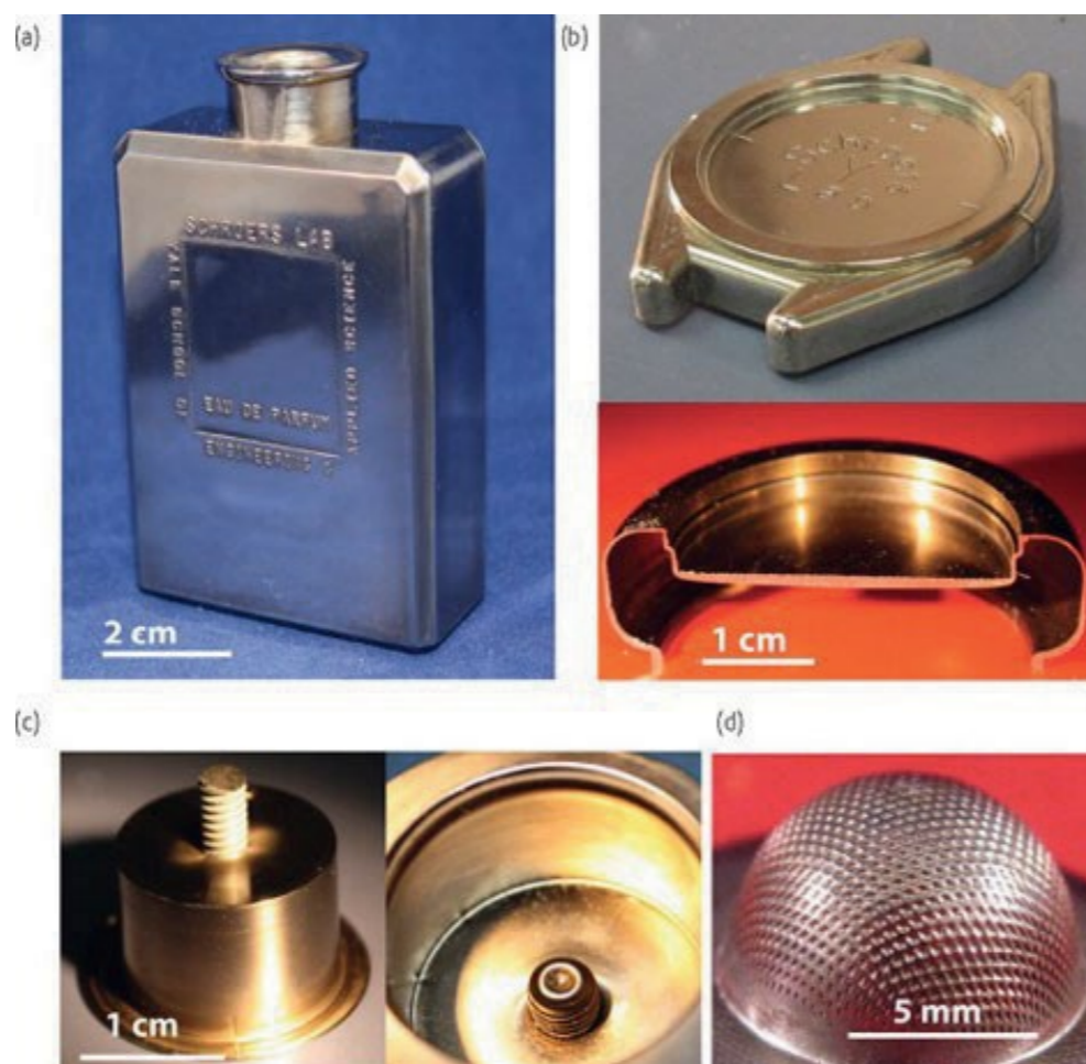
BMG может использоваться для создания сложных по форме предметов, например, корпуса часов. Источник: coge77.com
