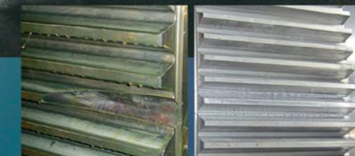
Отремонтированное зубчатое колесо
