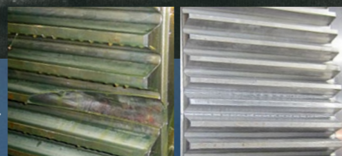
Отремонтированное зубчатое колесо
